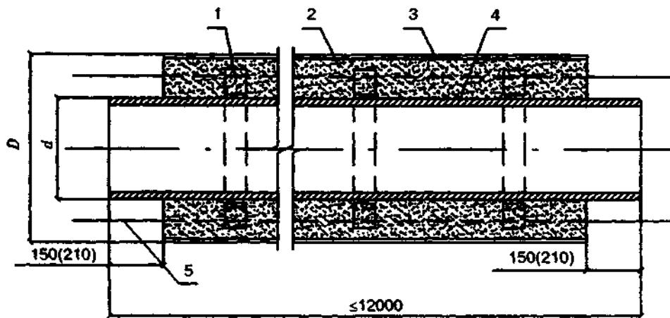
1 — центрирующая опора; 2 — изоляция из пенополиуретана; 3 — труба-оболочка из полипропиленса; 4 — стальная труба; 5 — проводники-индикаторы системы ОДК (показаны условно)
